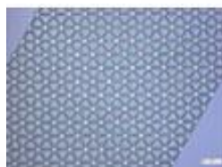
線幅3μm、銀ペースト
